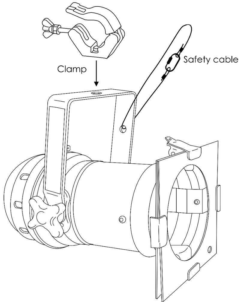
Die Parcan kann mit einer Schelle an einem beliebigen Traversenrahmen befestigt werden.
