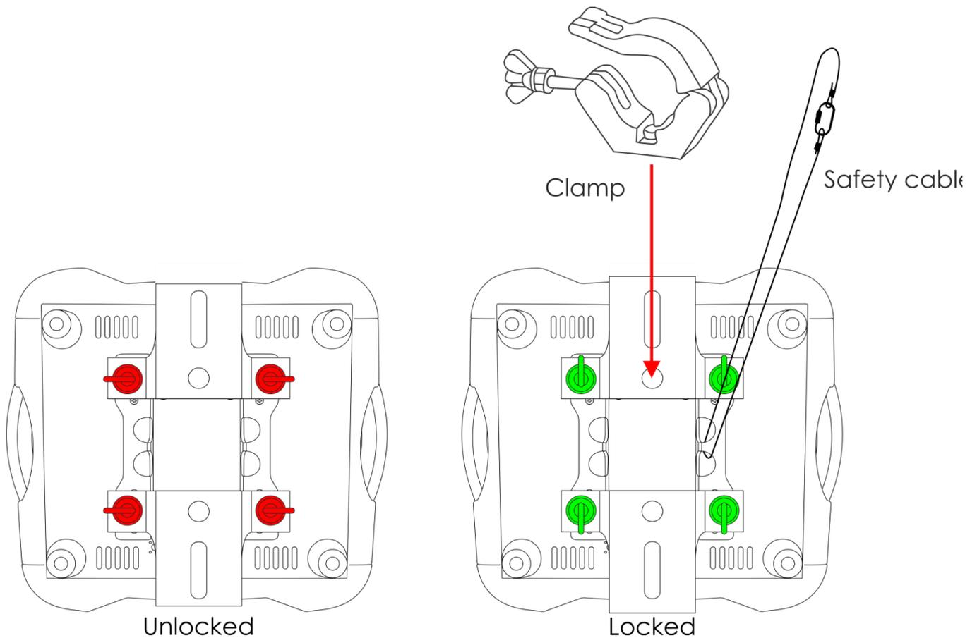
Der Infinity kann auf dem Boden einer flachen Bühne positioniert werden oder mit einer Montagehalterung und einer Schelle an einem Traversenrahmen befestigt werden.
